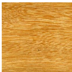
Struttura Yellow Balau
