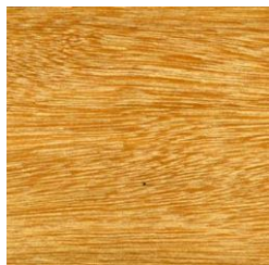
Struttura Yellow Balau
